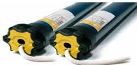
Motor Somfy cable tradicional, hasta 18kg con eje de 60mm o persianas aluminio térmico (5kg/m2) estándar de hasta 4m2 de superficie total de persiana y altura máxima de 2,5m. Con final de carrera por moleta . Fácil fijación de adaptadores de eje, cabeza con orificio central 12mm diámetro para colocación en cajones de persianas. Incluye solo soporte de motor.
