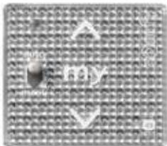
Punto de mando de pared táctil monocanal, en acabado Pure Shine. Permite accionar persianas, toldos, etc. Funciones subida, bajada y parada; posición preferida "MY" y función Auto/Manu (desconexión del mando general).
